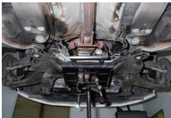
建議以拆卸口字樑後端，斜放取出更換防傾桿，須拆方向機固定螺絲
